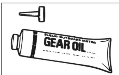
Используйте SUZUKI OUTBOARD MOTOR GEAR OIL или его эквивалент высокого качества, гипоидное трансмиссионное масло SAE90.
